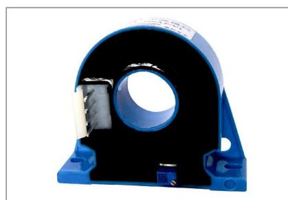
**性能参数:** 开关量输出—交流电流变送器: 额定电流 5A...500A RMS、可隔离测量交流电流、继电器输出—**开关量信号**
